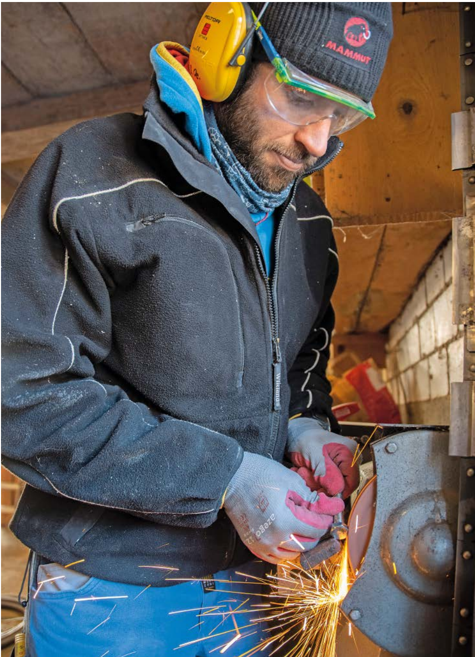
Die Inneneinrichtung des neuen Laufstalls macht Bruno selbst. Da gehört auch mal das Abfräsen eines zu grossen Schraubenkopfes dazu.
